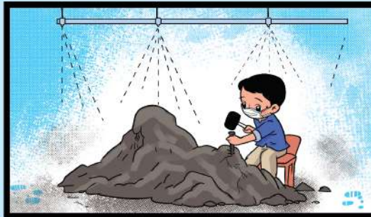
ลดการฟุ้งกระจายฝุ่น เช่น การใช้สปาร์กน้ำ หรือ พรหมน้ำลวงวัตถุที่ตัดแต่ง ให้ชุ่มก่อนขณะตัด
